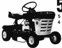
5 HORSEPOWER BRIGGS ENGINE 4 SPEED GEARED TRANSMISSION
